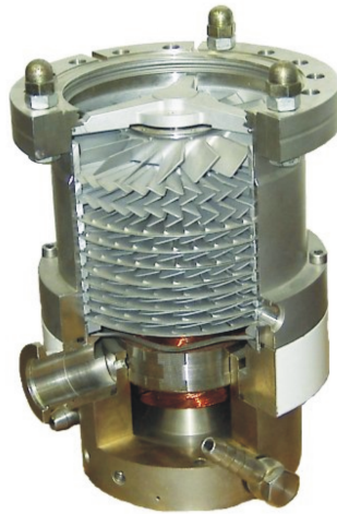
Abbildung 3.2: Schnitt durch eine Turbomolekularpumpe, deutlich zu sehen sind die verschiedenen Rotorblätter.
